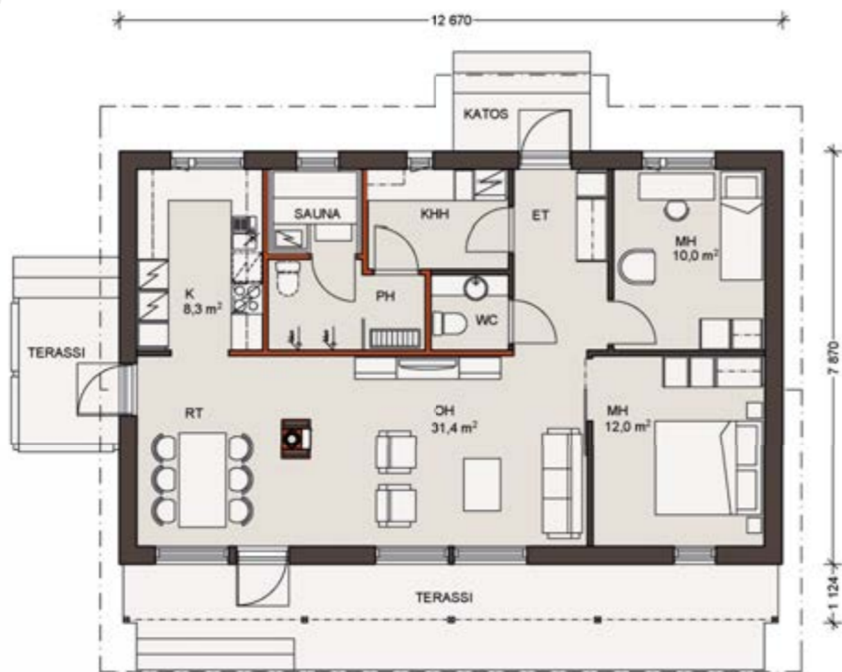
Mittakaava 1:100. Kerrosala on laskettu 250 mm ulkoseinävahvuuden mukaan.
