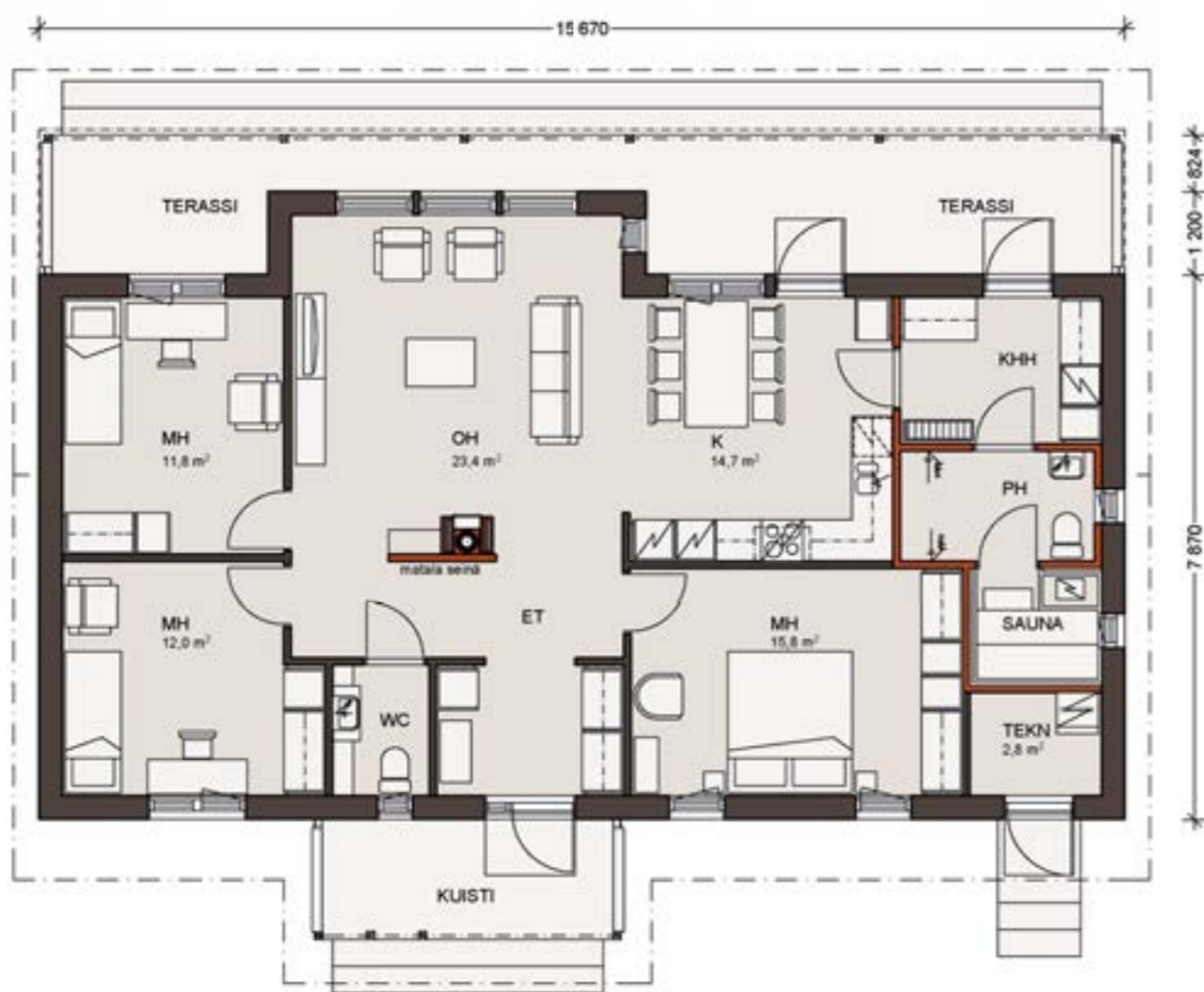
Mittakaava 1:100. Kerrosala on laskettu 250 mm ulkoseinävahvuuden mukaan.
