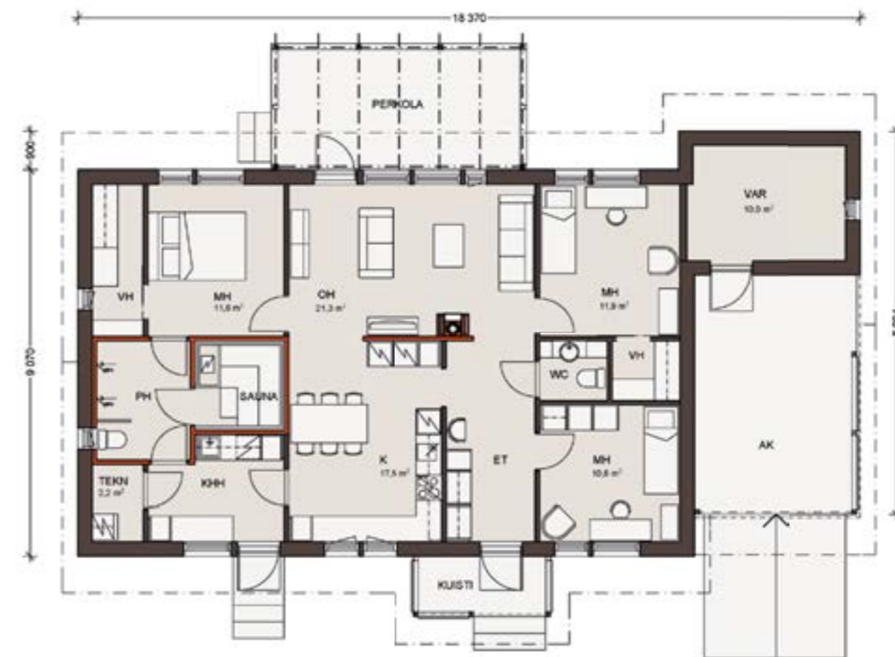
Mittakaava 1:125. Kerrosala on laskettu 250 mm ulkoseinävahvuuden mukaan.
