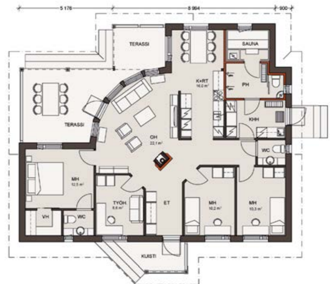
Mittakaava 1:125. Kerrosala on laskettu 250 mm ulkoseinävahvuuden mukaan.
