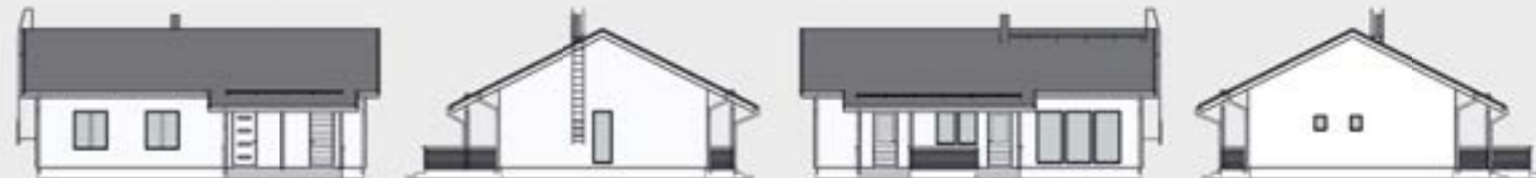
Mittakaava 1:125. Kerrosala on laskettu 250 mm ulkoseinävahvuuden mukaan.
