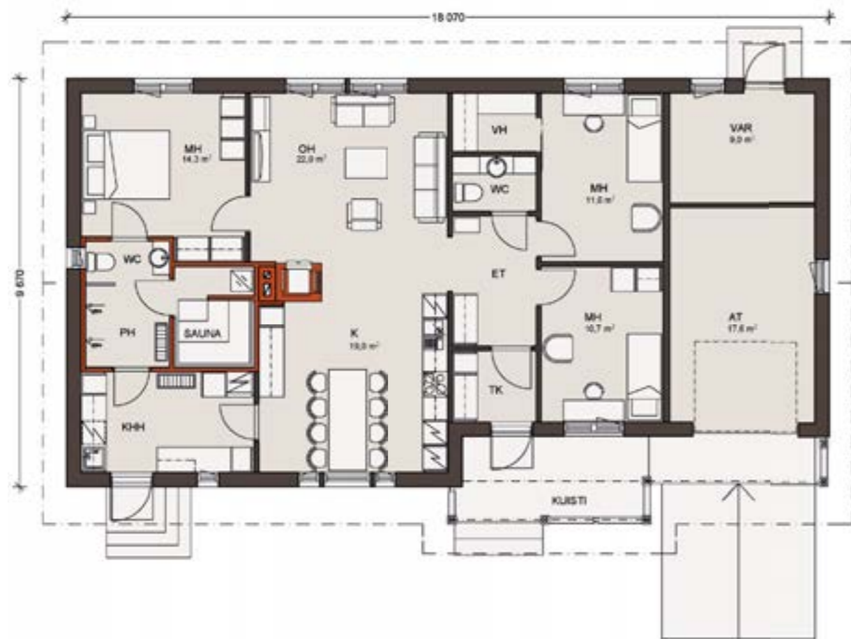
Mittakaava 1:125. Kerrosala on laskettu 250 mm ulkoseinävahvuuden mukaan.
