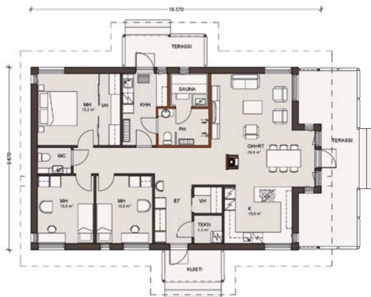
Mittakaava 1:125. Kerrosala on laskettu 250 mm ulkoseinävahvuuden mukaan.
