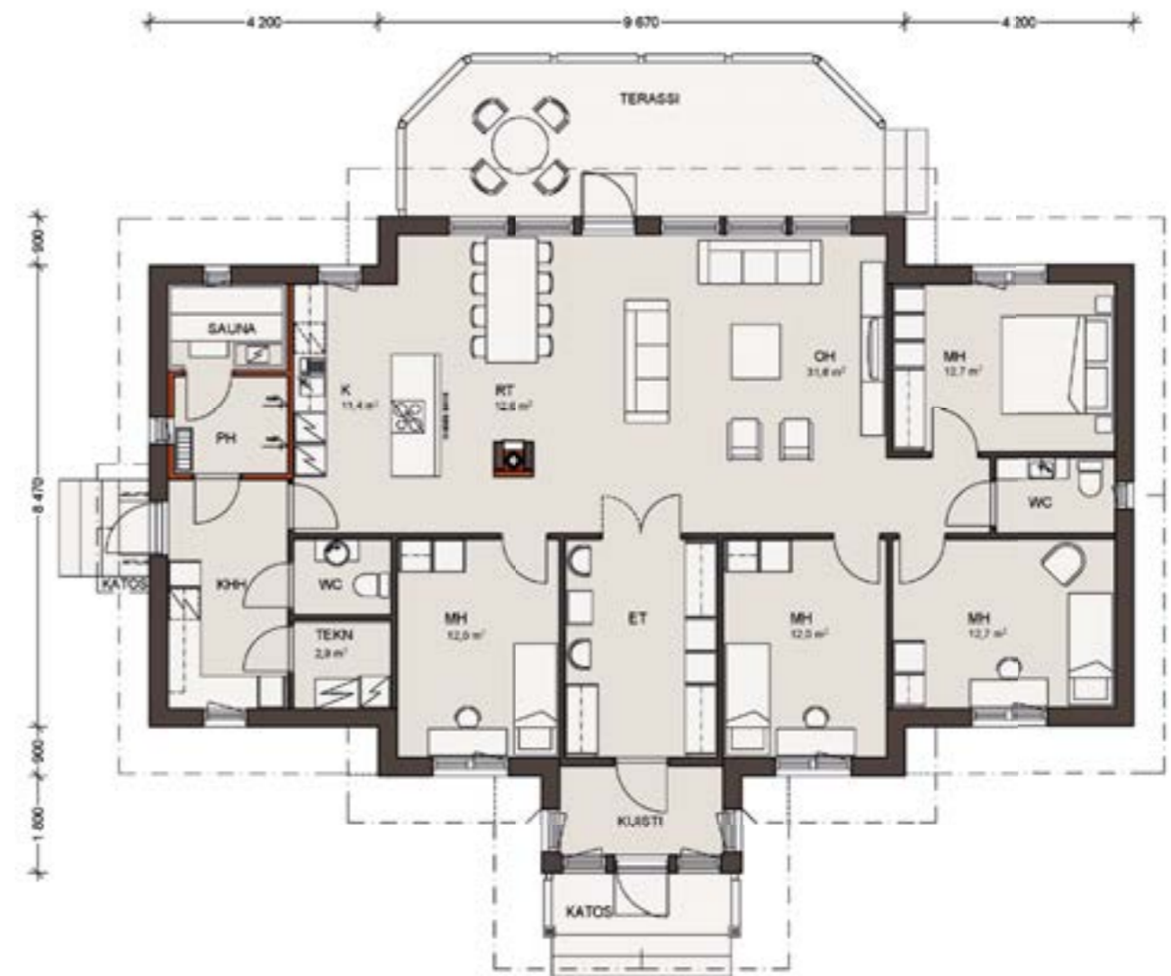
Mittakaava 1:125. Kerrosala on laskettu 250 mm ulkoseinävahvuuden mukaan.
