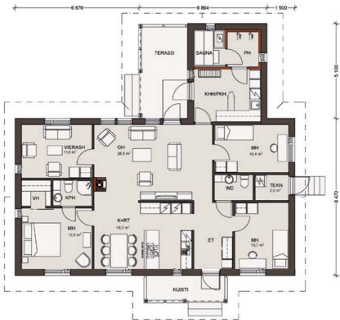
Mittakaava 1:125. Kerrosala on laskettu 250 mm ulkoseinävahvuuden mukaan.
