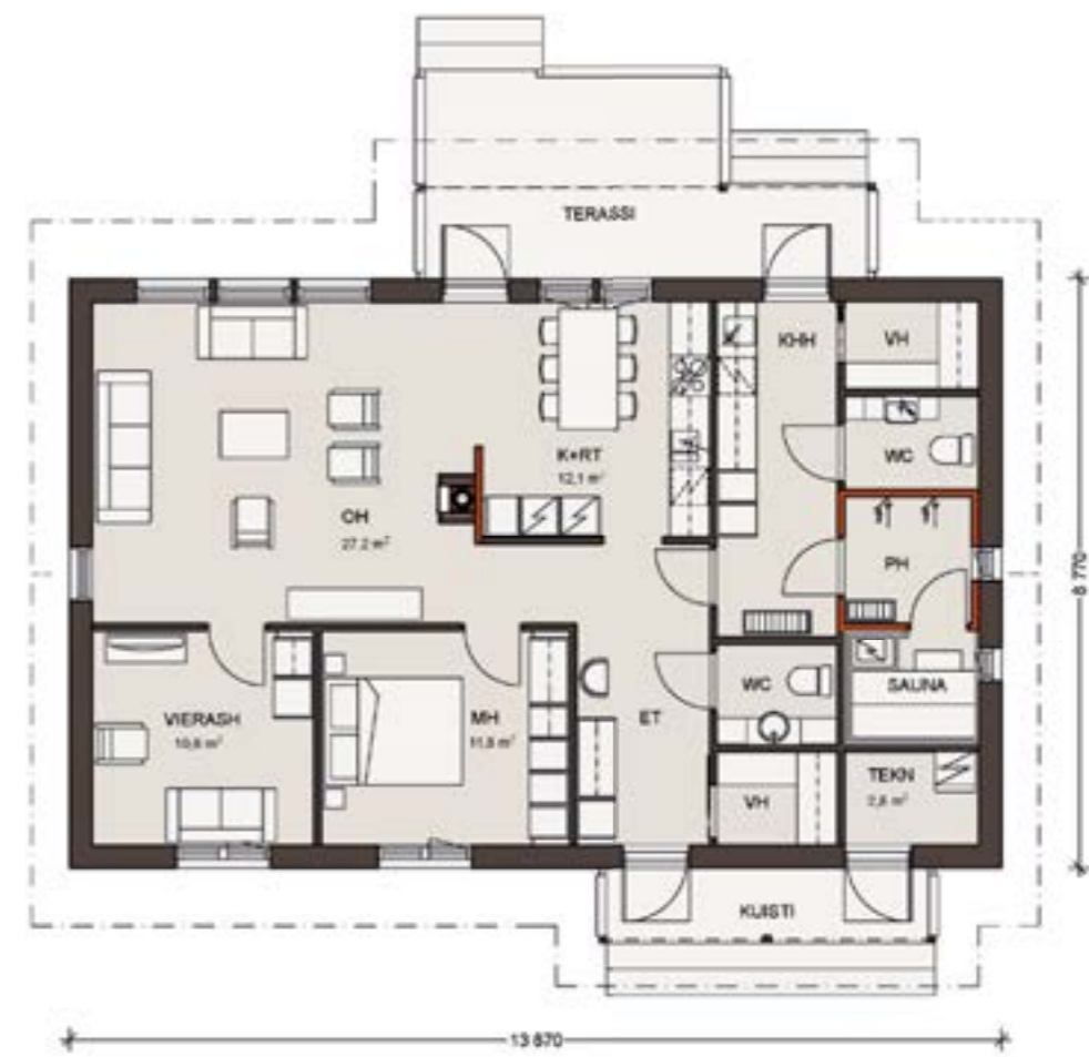
Mittakaava 1:125. Kerrosala on laskettu 250 mm ulkoseinävahvuuden mukaan.
