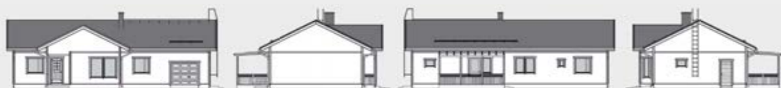
Mittakaava 1:125. Kerrosala on laskettu 250 mm ulkoseinävahvuuden mukaan.
