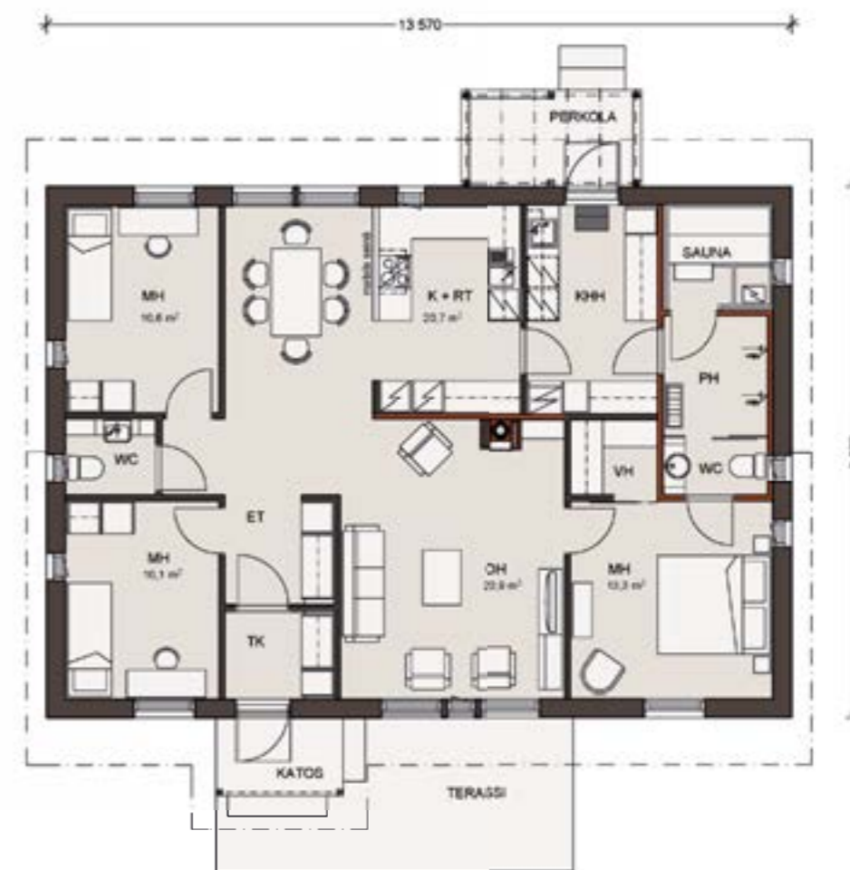
Mittakaava 1:125. Kerrosala on laskettu 250 mm ulkoseinävahvuuden mukaan.
