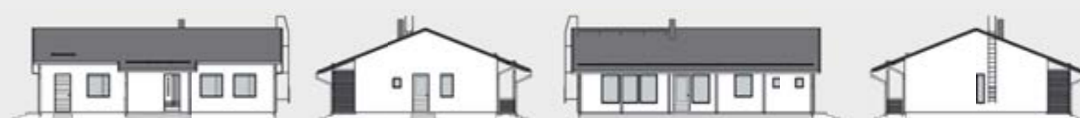
Mittakaava 1:100. Kerrosala on laskettu 250 mm ulkoseinävahvuuden mukaan.
