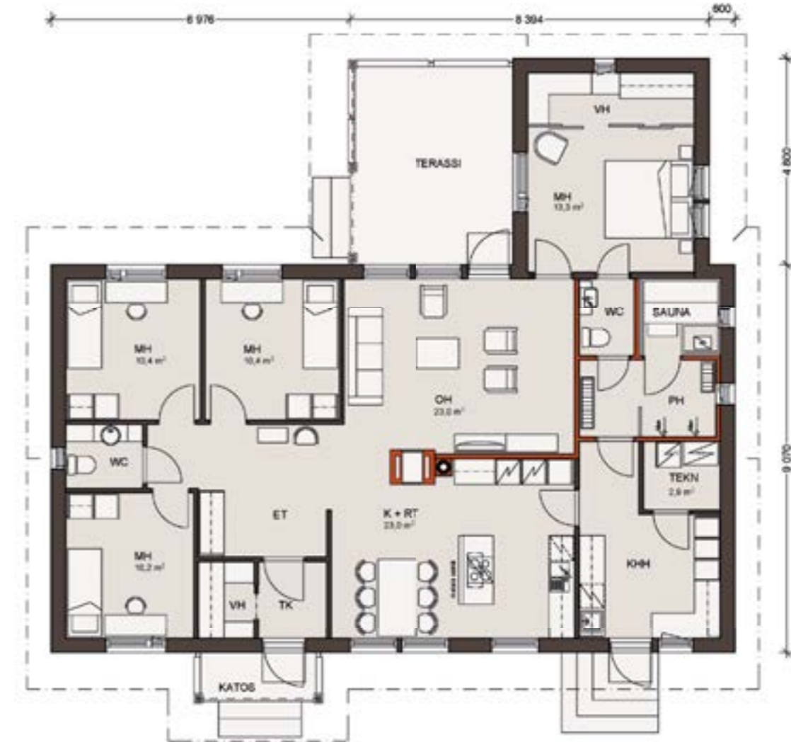
Mittakaava 1:125. Kerrosala on laskettu 250 mm ulkoseinävahvuuden mukaan.
