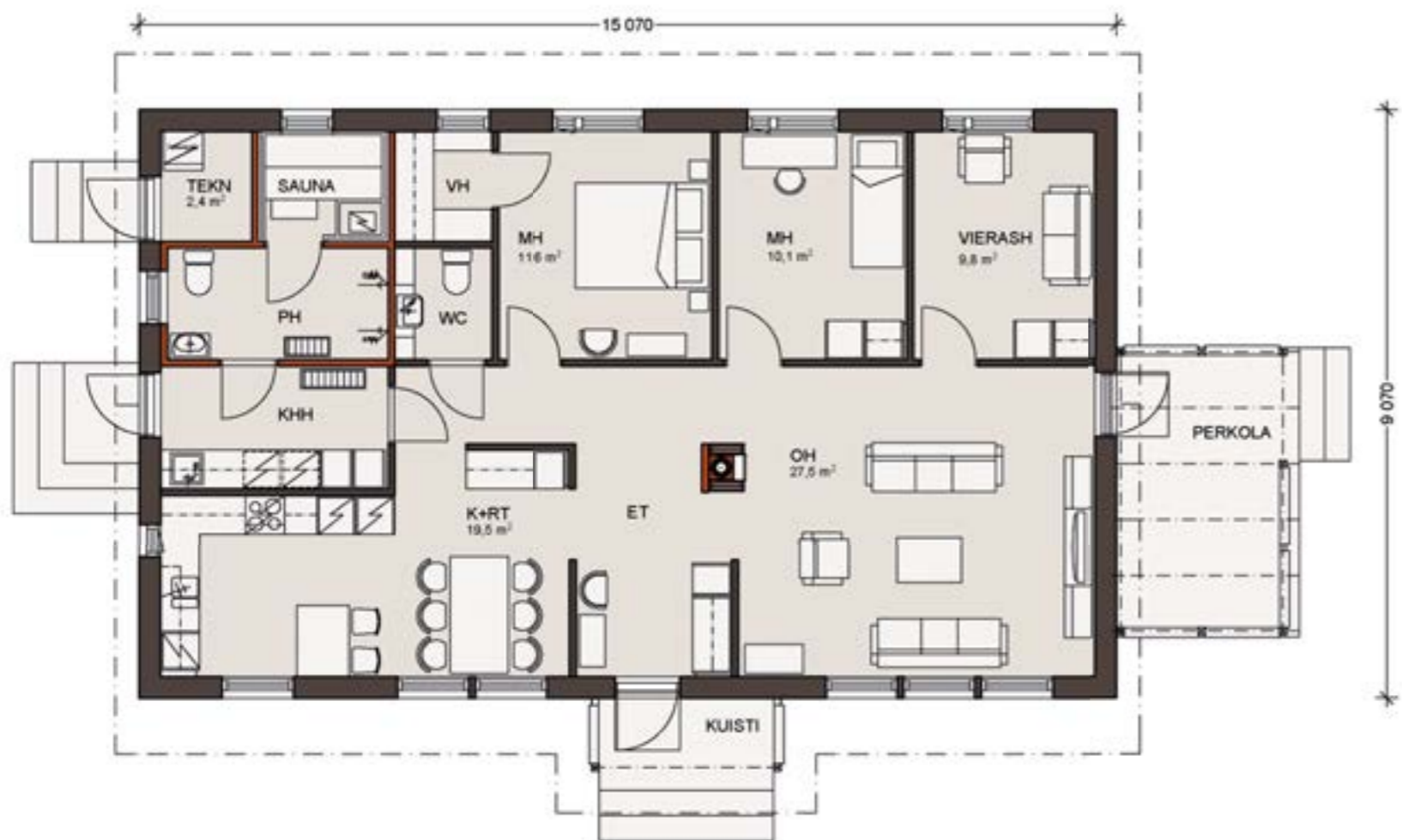
Mittakaava 1:100. Kerrosala on laskettu 250 mm ulkoseinävahvuuden mukaan.
