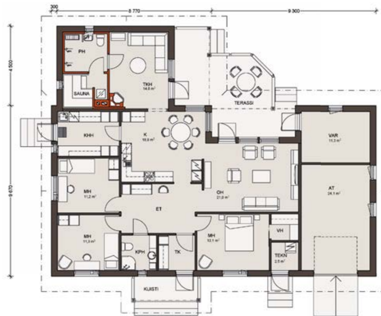
Mittakaava 1:125. Kerrosala on laskettu 250 mm ulkoseinävahvuuden mukaan.
