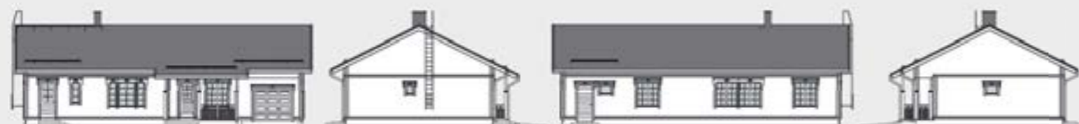
Mittakaava 1:125. Kerrosala on laskettu 250 mm ulkoseinävahvuuden mukaan.
