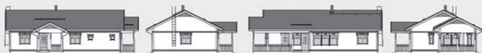
Mittakaava 1:125. Kerrosala on laskettu 250 mm ulkoseinävahvuuden mukaan.
