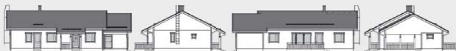
Mittakaava 1:125. Kerrosala on laskettu 250 mm ulkoseinävahvuuden mukaan.
