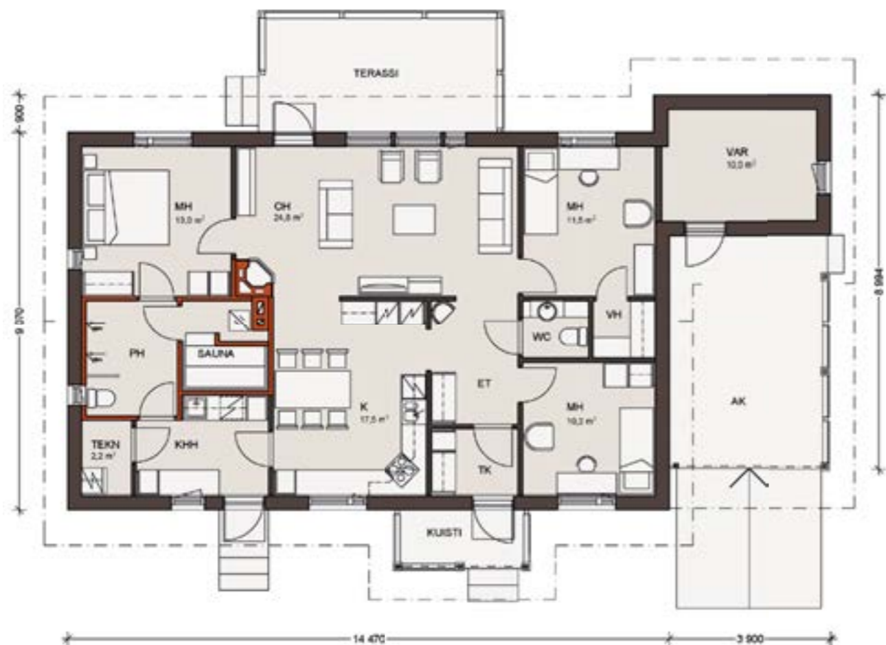
Mittakaava 1:125. Kerrosala on laskettu 250 mm ulkoseinävahvuuden mukaan.
