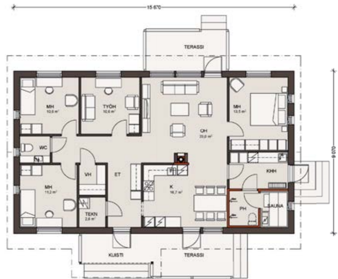
Mittakaava 1:125. Kerrosala on laskettu 250 mm ulkoseinävahvuuden mukaan.
