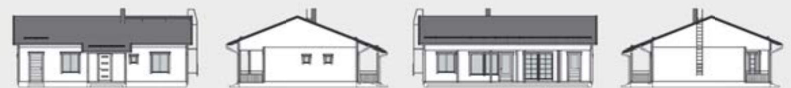
Mittakaava 1:100. Kerrosala on laskettu 250 mm ulkoseinävahvuuden mukaan.
