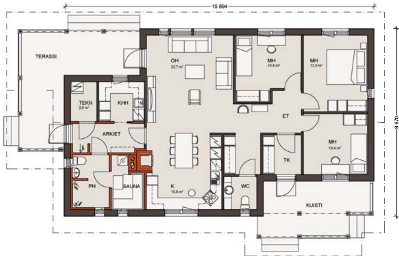
Mittakaava 1:100. Kerrosala on laskettu 250 mm ulkoseinävahvuuden mukaan.
