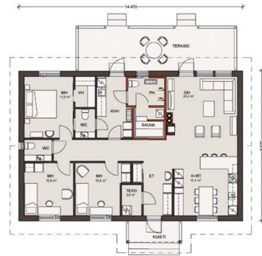
Mittakaava 1:125. Kerrosala on laskettu 250 mm ulkoseinävahvuuden mukaan.
