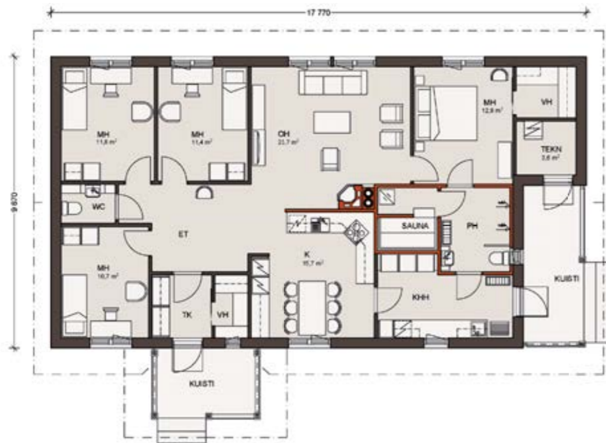
Mittakaava 1:125. Kerrosala on laskettu 250 mm ulkoseinävahvuuden mukaan.
