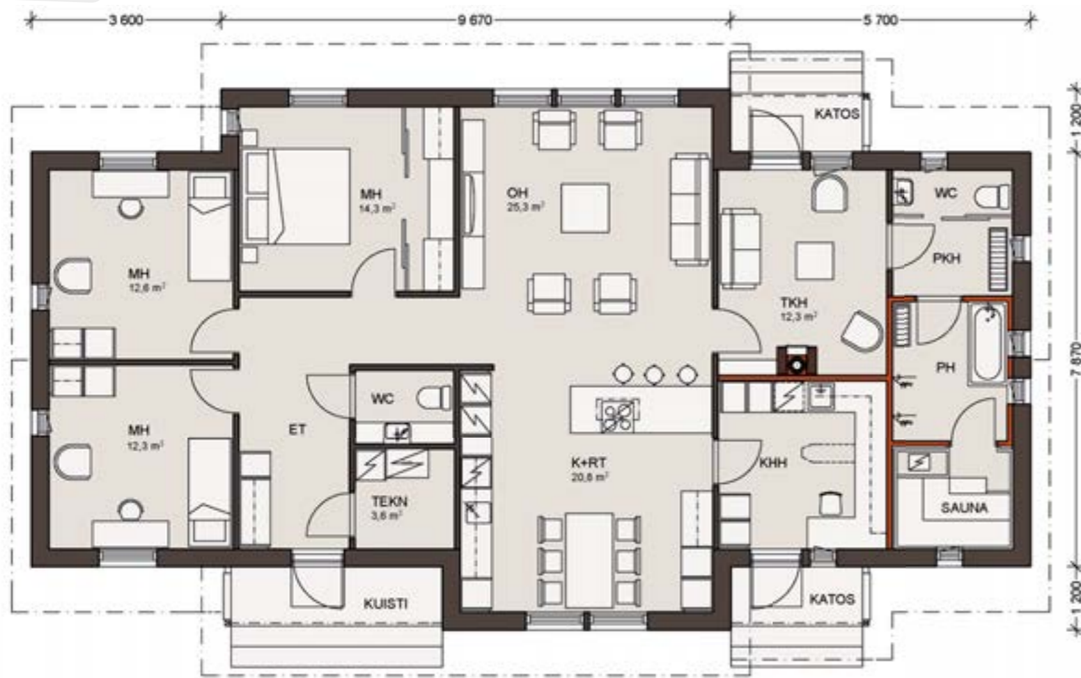
Mittakaava 1:100. Kerrosala on laskettu 250 mm ulkoseinävahvuuden mukaan.
