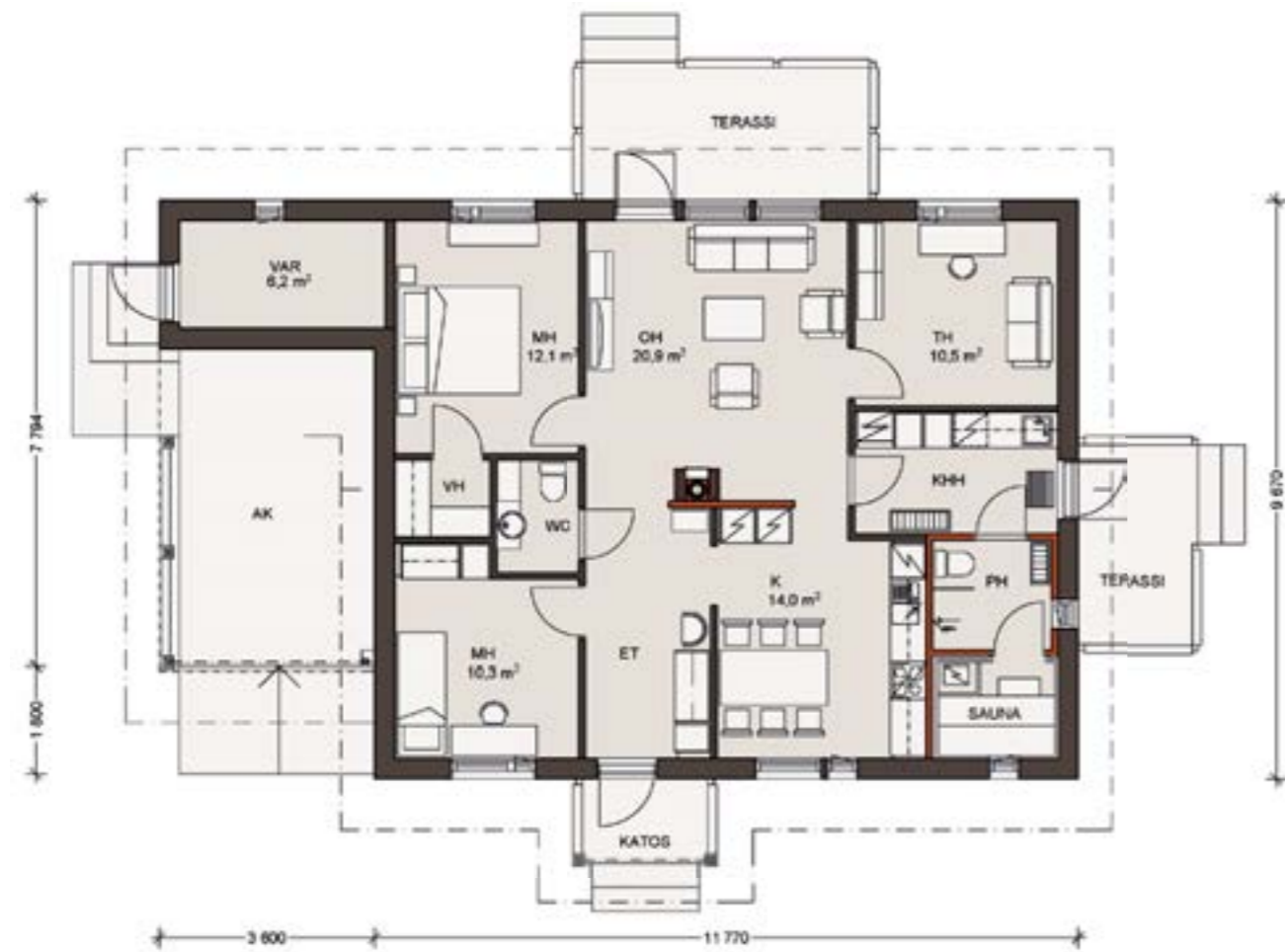
Mittakaava 1:125. Kerrosala on laskettu 250 mm ulkoseinävahvuuden mukaan.
