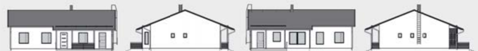
Mittakaava 1:125. Kerrosala on laskettu 250 mm ulkoseinävahvuuden mukaan.
