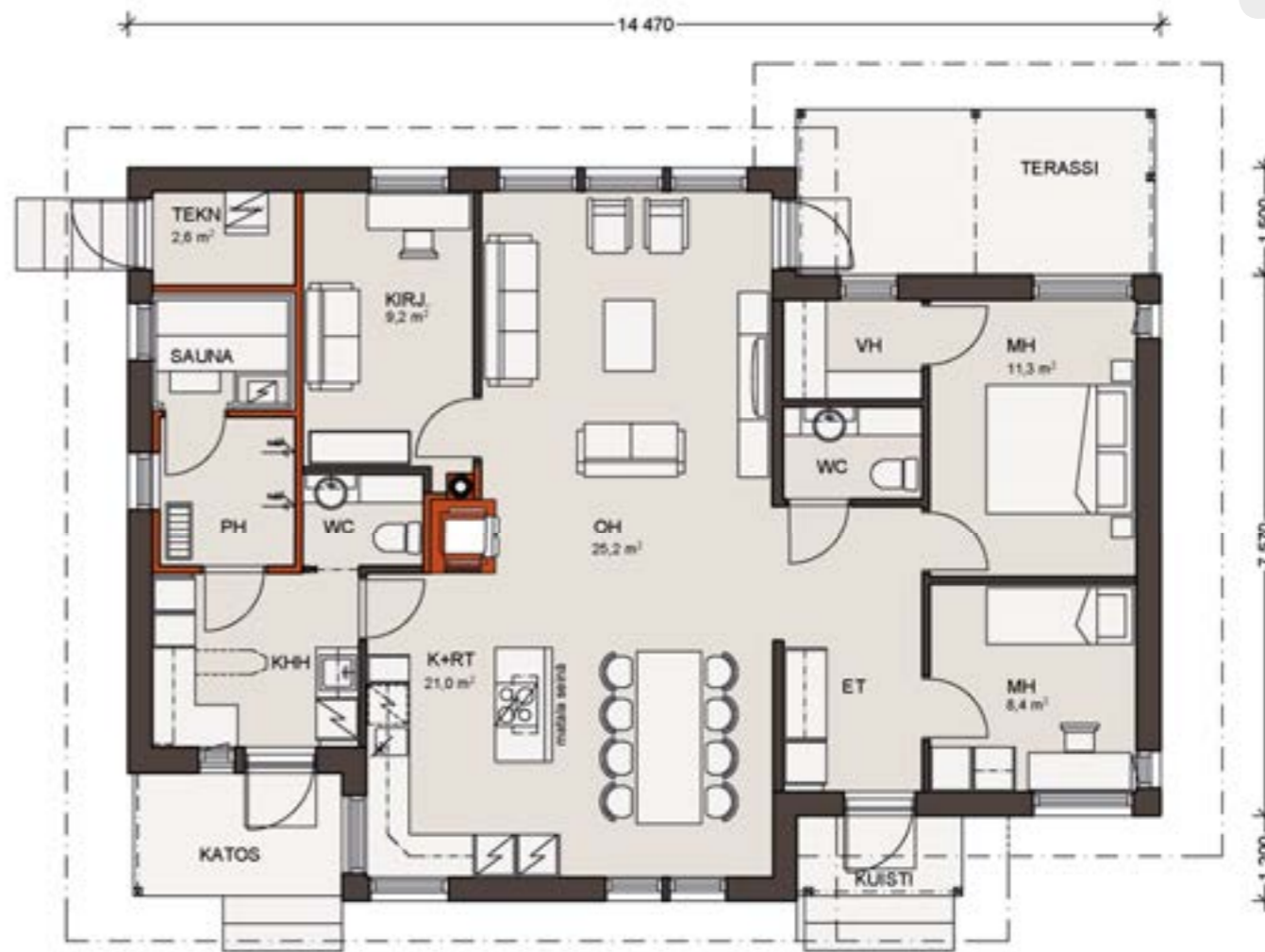
Mittakaava 1:100. Kerrosala on laskettu 250 mm ulkoseinävahvuuden mukaan.
