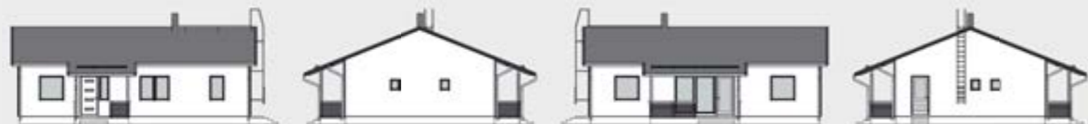
Mittakaava 1:100. Kerrosala on laskettu 250 mm ulkoseinävahvuuden mukaan.
