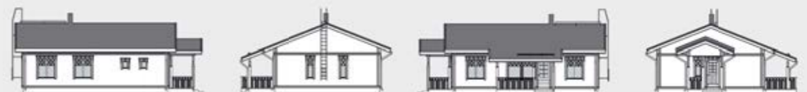
Mittakaava 1:100. Kerrosala on laskettu 250 mm ulkoseinävahvuuden mukaan.
