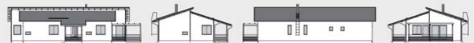
Mittakaava 1:100. Kerrosala on laskettu 250 mm ulkoseinävahvuuden mukaan.
