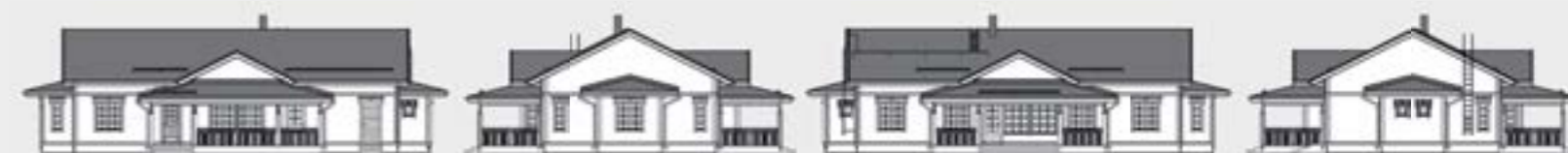
Mittakaava 1:150. Kerrosala on laskettu 250 mm ulkoseinävahvuuden mukaan.
