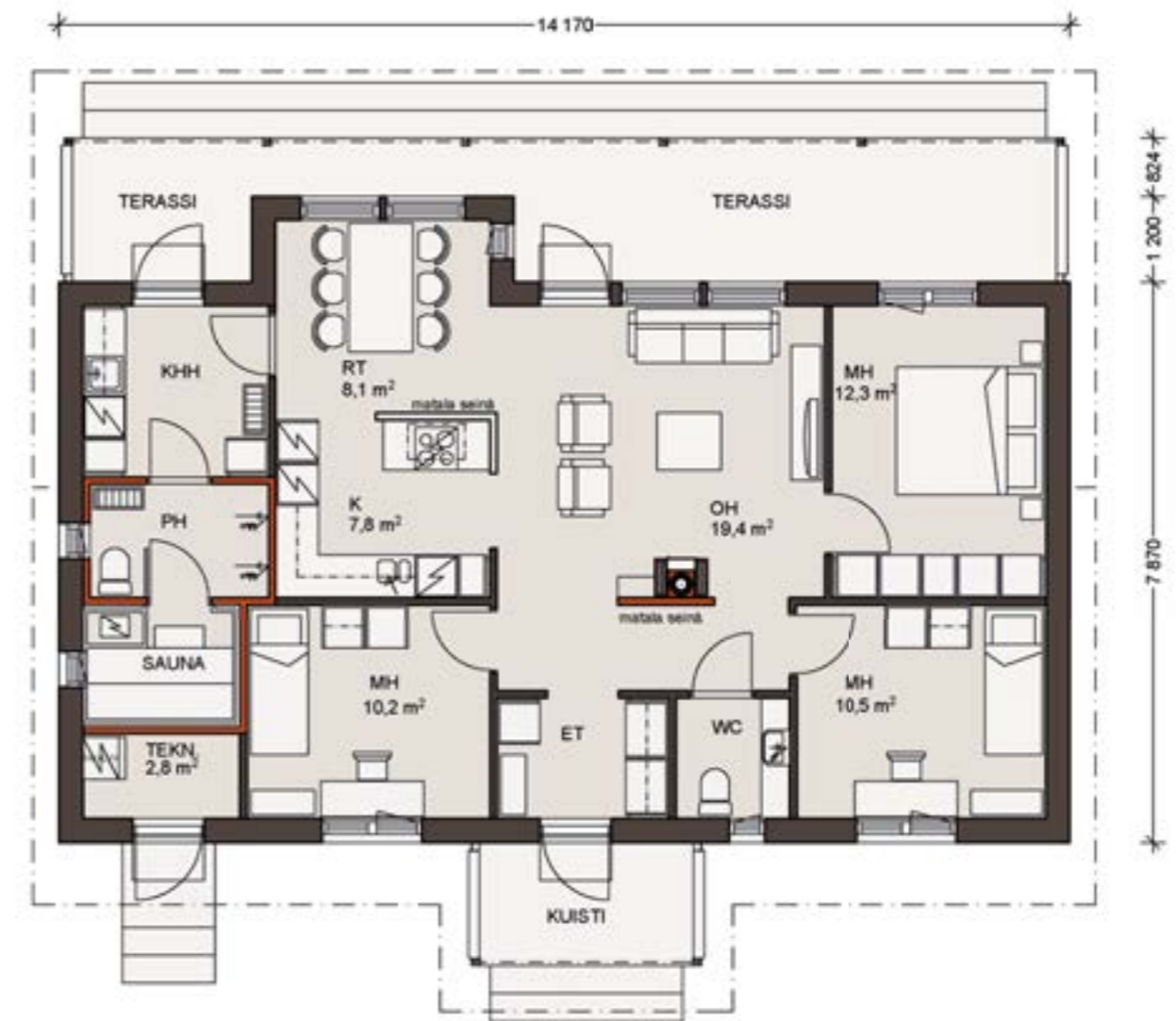
Mittakaava 1:100. Kerrosala on laskettu 250 mm ulkoseinävahvuuden mukaan.
