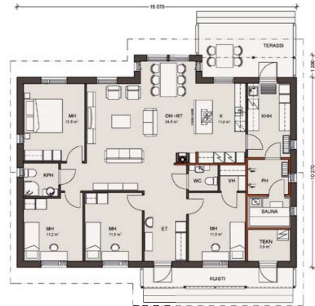
Mittakaava 1:125. Kerrosala on laskettu 250 mm ulkoseinävahvuuden mukaan.
