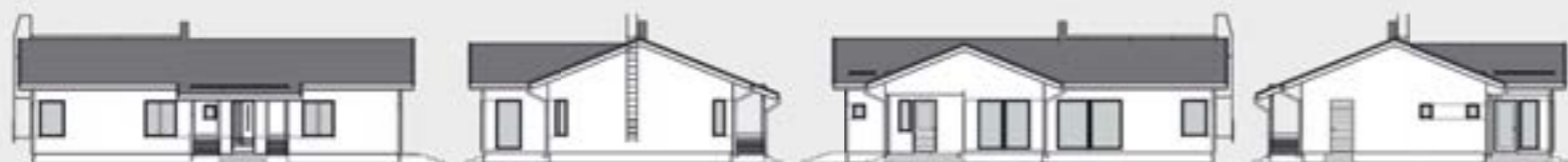
Mittakaava 1:125. Kerrosala on laskettu 250 mm ulkoseinävahvuuden mukaan.
