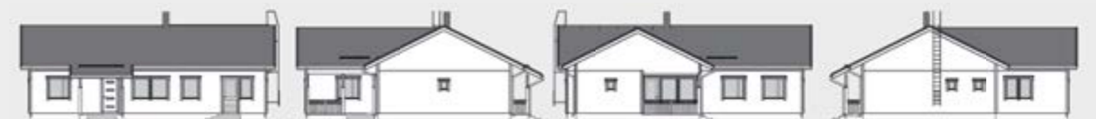
Mittakaava 1:125. Kerrosala on laskettu 250 mm ulkoseinävahvuuden mukaan.
