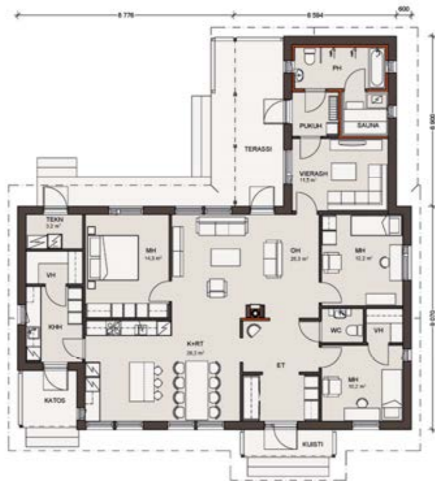
Mittakaava 1:150. Kerrosala on laskettu 250 mm ulkoseinävahvuuden mukaan.
