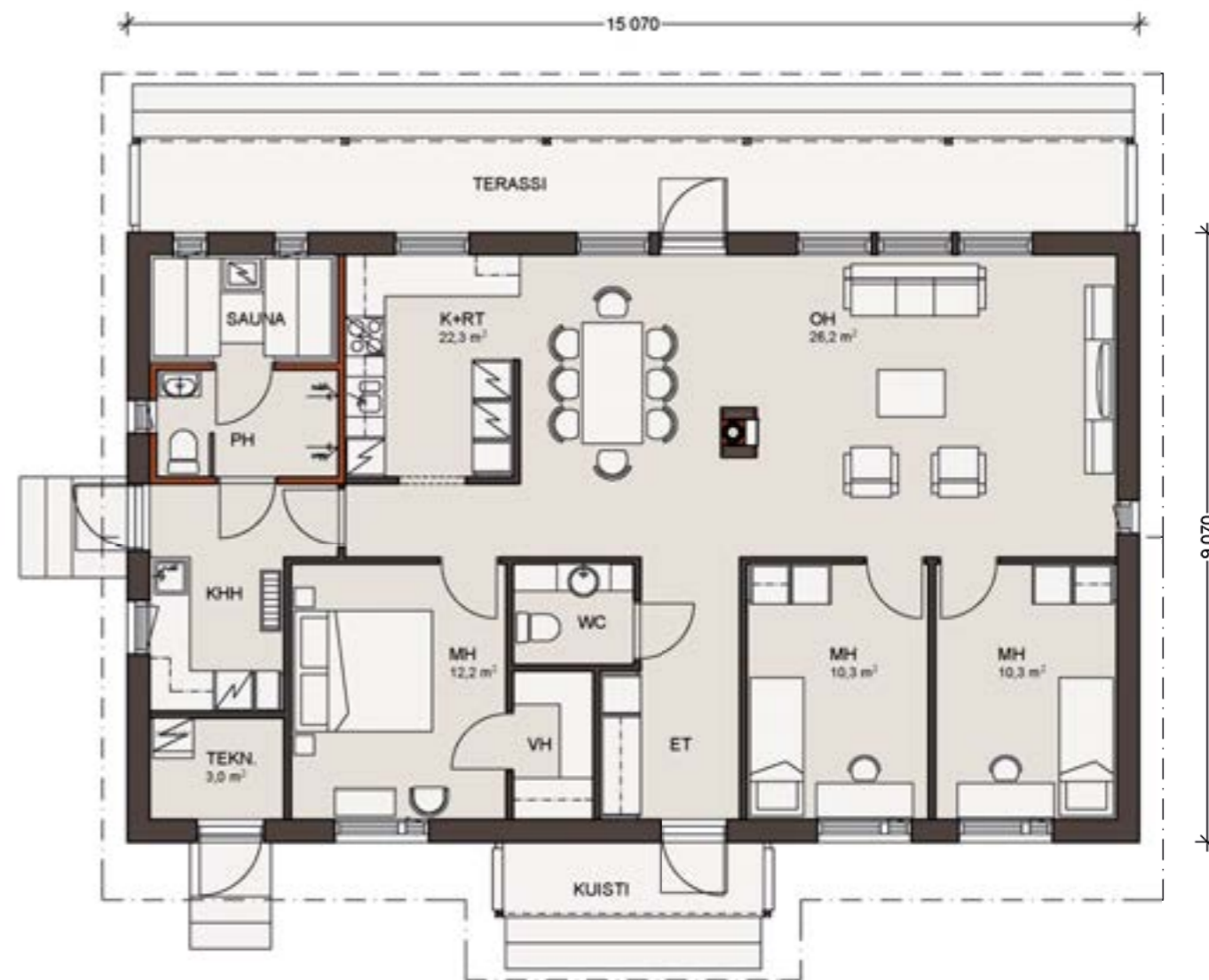
Mittakaava 1:100. Kerrosala on laskettu 250 mm ulkoseinävahvuuden mukaan.
