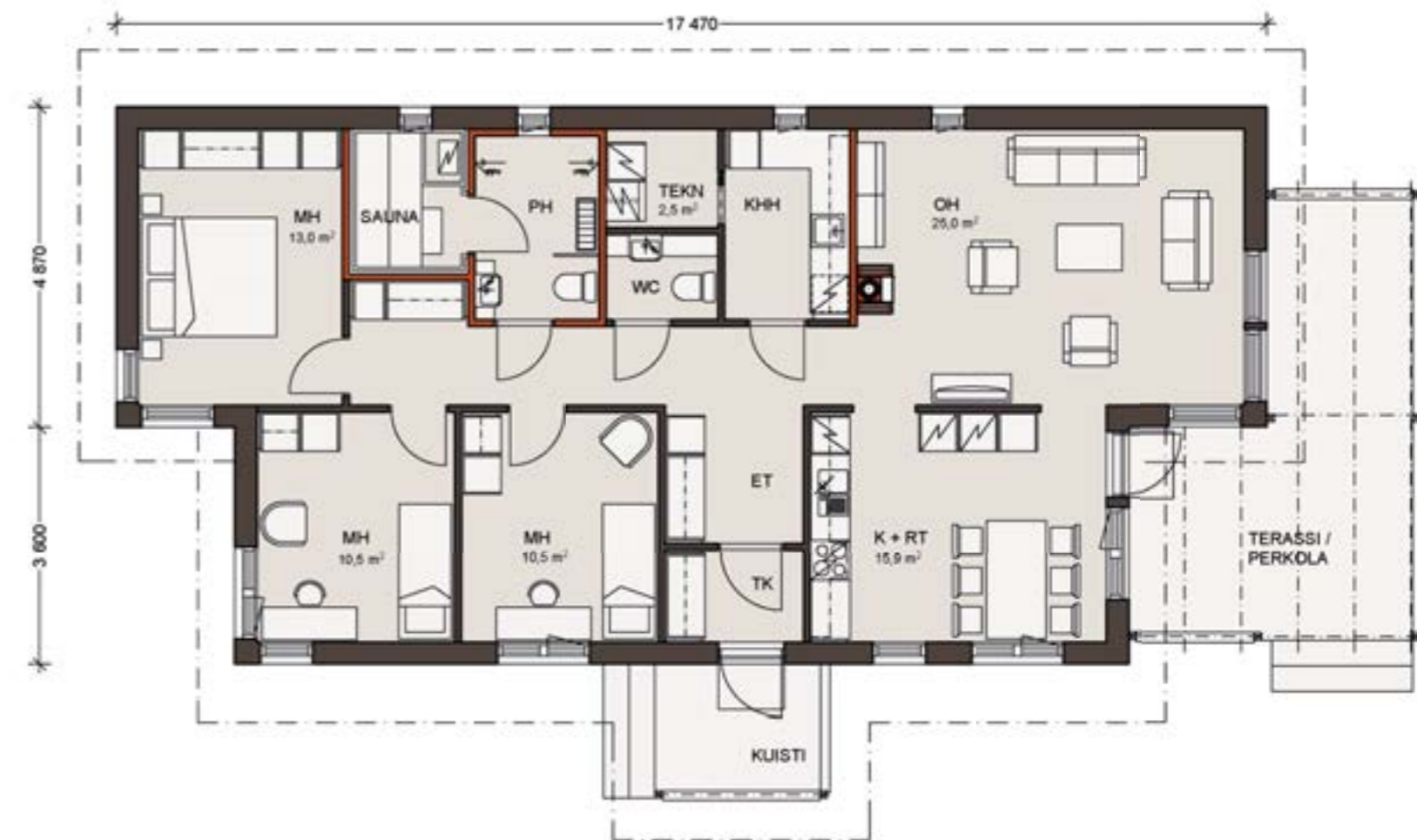
Mittakaava 1:100. Kerrosala on laskettu 250 mm ulkoseinävahvuuden mukaan.
