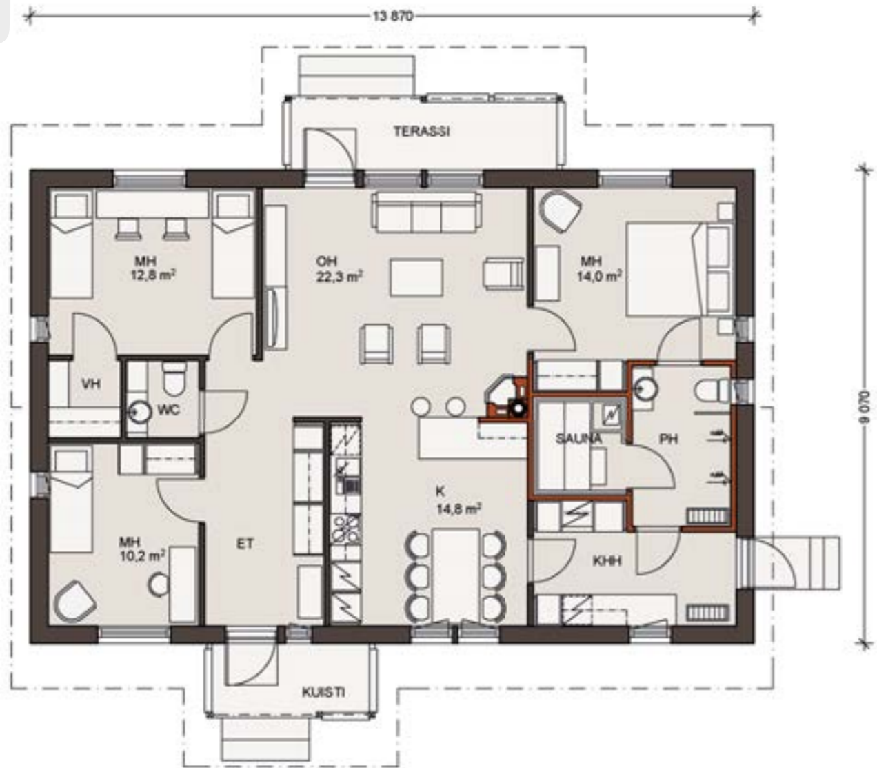
Mittakaava 1:100. Kerrosala on laskettu 250 mm ulkoseinävahvuuden mukaan.
