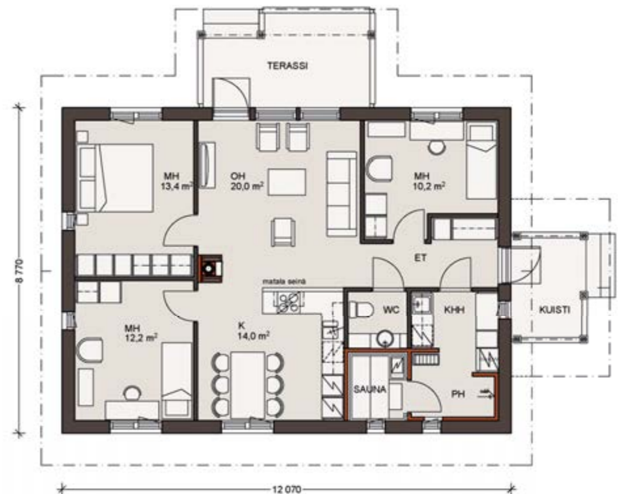
Mittakaava 1:100. Kerrosala on laskettu 250 mm ulkoseinävahvuuden mukaan.
