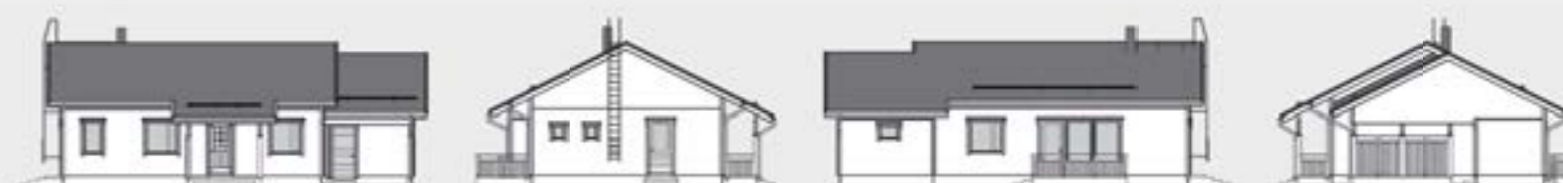
Mittakaava 1:100. Kerrosala on laskettu 250 mm ulkoseinävahvuuden mukaan.
