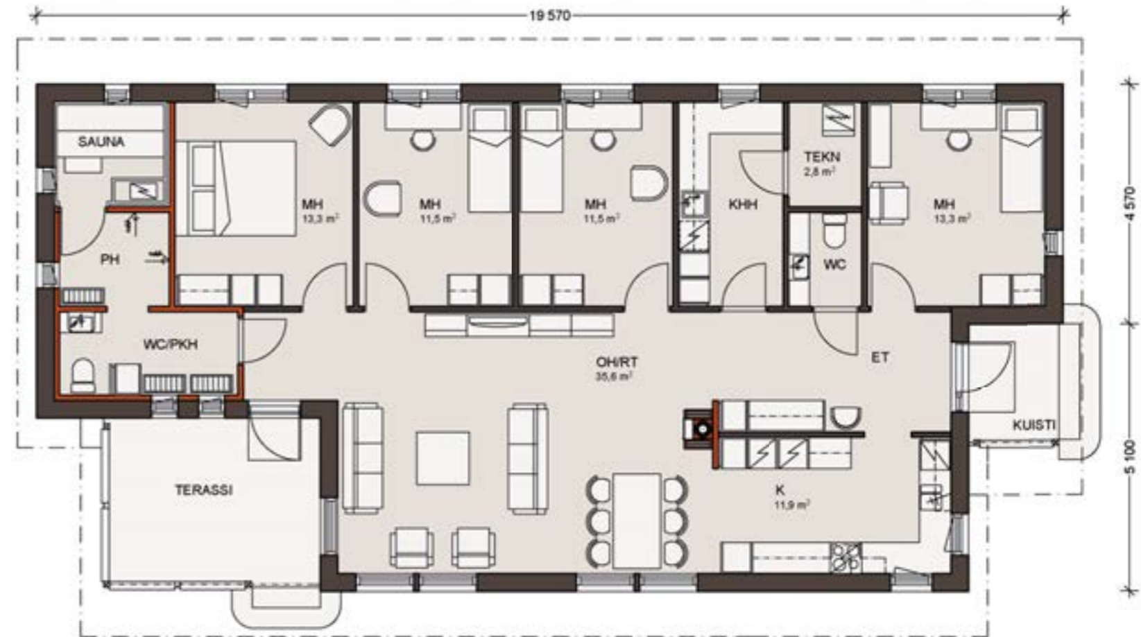
Mittakaava 1:100. Kerrosala on laskettu 250 mm ulkoseinävahvuuden mukaan.
