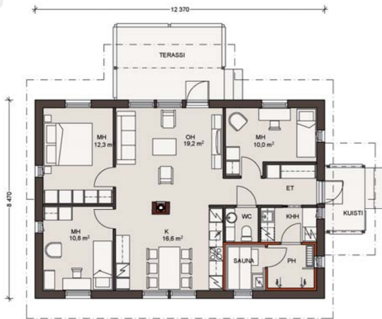
Mittakaava 1:100. Kerrosala on laskettu 250 mm ulkoseinävahvuuden mukaan.
