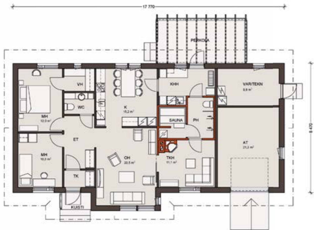
Mittakaava 1:125. Kerrosala on laskettu 250 mm ulkoseinävahvuuden mukaan.
